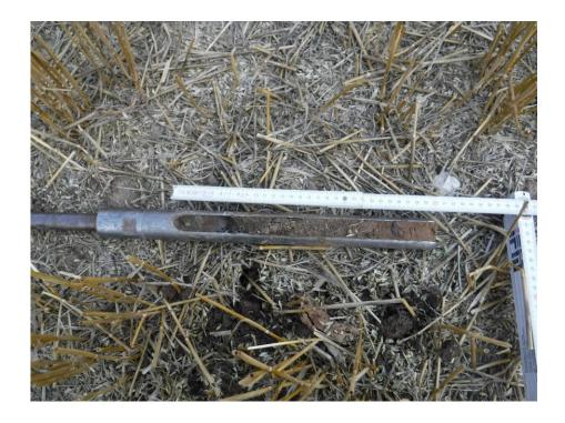
Bild 3: Bohrstock 0-30 cm
